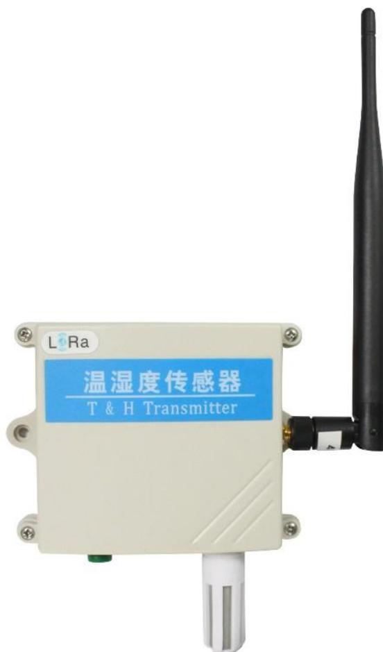
SL2110 采用工业通用标准 LORA 无线通讯接口接口,方便接入 PLC,DCS 等各种仪表或系统,用于监测温度,湿度等状态量。内部使用了较高精度的传感内核及相关器件,确保产品具有较高的可靠性与卓越的长期稳定性,可定制 RS232、RS485、CAN、4-20mA、DC0~5V\10V、ZIGBEE、Lora、WIFI、GPRS、NB-IOT 等多种输出方式。
