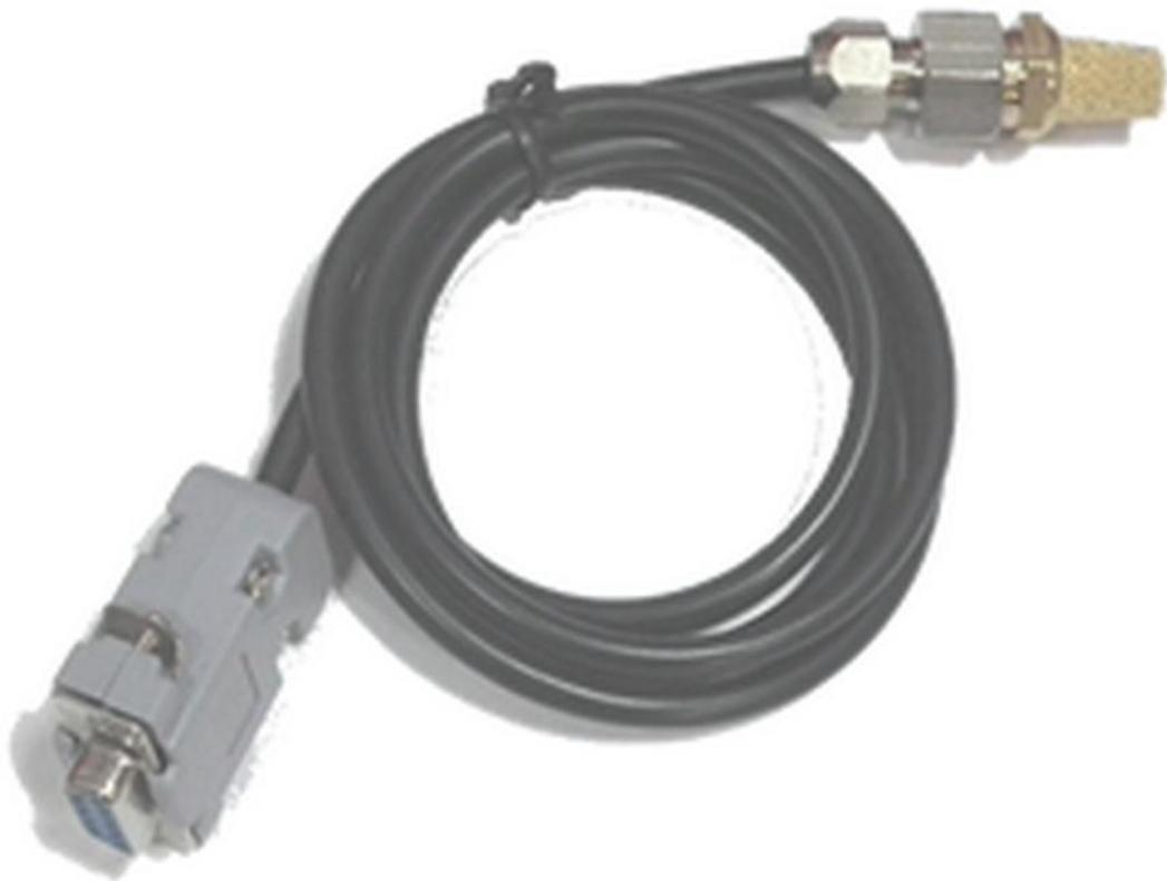
SLHT12 包括 SLHT12-1、SLHT12-2、SLHT12-3 共 3 种型号。串口防护型数字温湿度传感器并没有实际 RS232 串口通讯功能，本产品只是为方便用户的接线座为 DB9 串口而设计的，用户特殊接法可与我司联系订制。产品标配 1 米线长，最长支持 100 米，用户有长线要求可订制。
