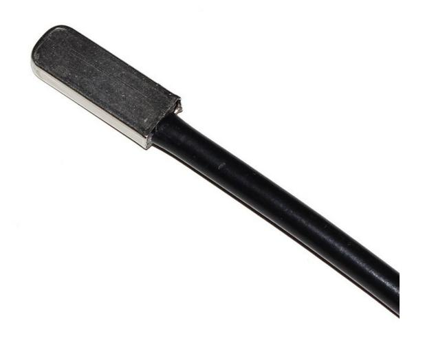
搜博 SLST2 系列 PT100 传感器铂电阻采用纯度为 99. 9995%的铂丝绕制,其性能稳定,重复性好,精度高,在一定的温度范围内具有良好的线性,是国际公认的成熟产品,国际温标 ITS-90中还规定,将具有特殊构造的铂电阻作为 13. 5033K--961. 78℃标准温度计来使用。铂电阻广泛用于-200--850℃范围内的温度测量,工业中通常在 600℃以下, SLST2 不同型号的测温范围参见技术参数. 极低的功耗,使 SLST2-X 成为各类应用的首选。
