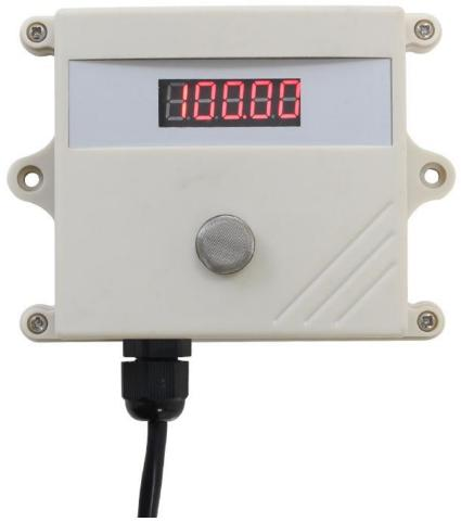
SD2130V-NH3 采用工业通用标准 DC0~10V 电压输出信号接口,方便接入 PLC, DCS 等各种仪表或系统,用于监测氨气等状态量。内部使用了较高精度的传感内核及相关器件,确保产品具
