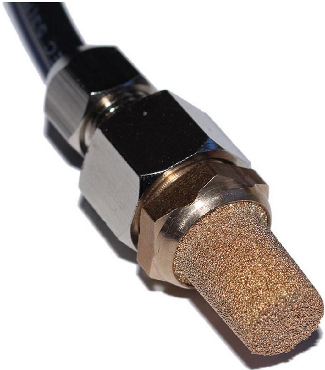
SLHT1 根据内置进口芯片的型号不同,分为 SLHT1-1(内置 SHT10)、SLHT1-2(内置 SHT11)、SLHT1-3(内置 SHT15)、SLHT1-4(内置 SHT71)、SLHT1-5(内置 SHT75)、SLHT1-6(内置 SHT20)、SLHT1-7(内置 SHT21)、SLHT1-8(内置 SHT25)、SLHT1-9(内置 SHT30)共 9 种型号。防护型能够有效阻止灰尘等颗粒进入传感器芯片,从而达到防护目的,延长传感器使用寿命。产品标配 1 米线长最长支持 100 米,用户有长线要求可订制。用户编程请参考瑞士 SHT 原厂说明书及我司提供的资料包,接线及使用电源请严格按照说明操作,切记接线正确并检查后再通电。
