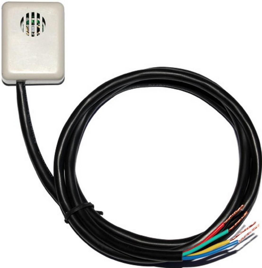
SLHT9 根据内置进口芯片的型号不同,分为 SLHT9-1(内置 SHT10)、SLHT9-2(内置 SHT11)、SLHT9-3(内置 SHT15)、SLHT9-4(内置 SHT71)、SLHT9-5(内置 SHT75)、SLHT9-6(内置 SHT20)、SLHT9-7(内置 SHT21)、SLHT9-8(内置 SHT25)、SLHT9-9(内置 SHT30)共 9 种型号。微型壁挂式数字温湿度传感器常用于室内温湿度测量,其体积小,可灵活用于各种场合。产品标配 1 米线长最长支持 100 米,用户有长线要求可订制。用户编程请参考瑞士 SHT 原厂说明书及我司提供的资料包,接线及使用电源请严格按照说明操作,切记接线正确并检查后再通电。
