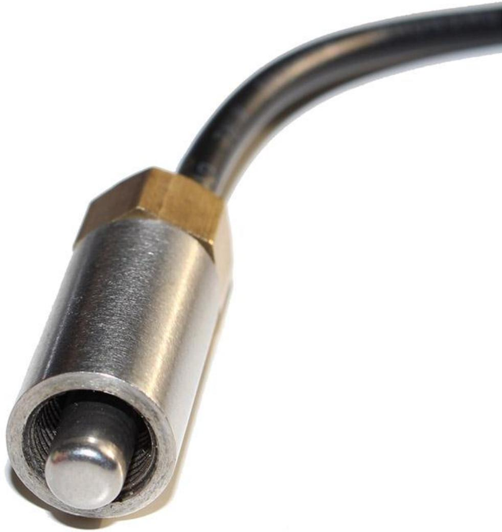
搜博 SLST2 系列 PT100 传感器铂电阻采用纯度为 99.9995% 的铂丝绕制，其性能稳定，重复性好，精度高，在一定的温度范围内具有良好的线性，是国际公认的成熟产品，国际温标 ITS-90 中还规定，将具有特殊构造的铂电阻作为 13.5033K--961.78°C 标准温度计来使用。铂电阻广泛用于 -200--850°C 范围内的温度测量，工业中通常在 600°C 以下，SLST2 不同型号的测温范围参见技术参数。极低的功耗，使 SLST2-X 成为各类应用的首选。
