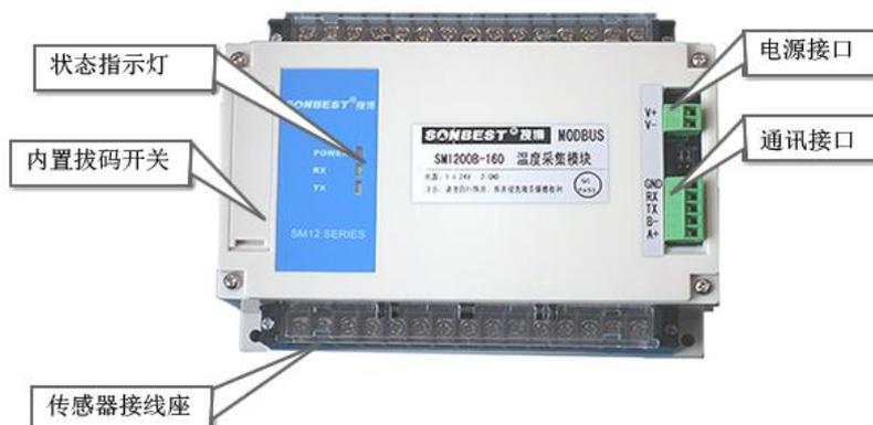
如上图所示，设备由电源接口、RS485 接口、传感器接线座、状态指示灯、校准按键及拨码开关等几部分组成。
