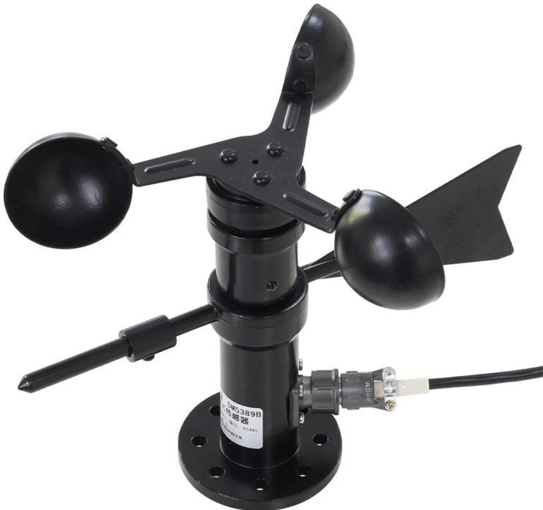
SM5389V 采用工业通用标准接口，方便接入 PLC，DCS 等各种仪表或系统，用于监测风速，风向等状态量。内部使用了较高精度的传感内核及相关器件，确保产品具有较高的可靠性与卓越的长期稳定性，可定制 RS232、RS485、CAN、4-20mA、DC0~5V\10V、ZIGBEE、Lora、WIFI、GPRS、NB-IOT 等多种输出方式。
