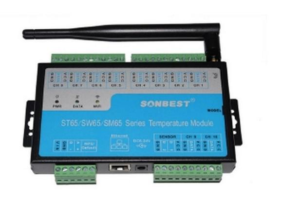
SM6501T 采用工业通用标准 TCP/IP 网络接口接口,方便接入 PLC, DCS 等各种仪表或系统,用于监测温度等状态量。内部使用了较高精度的传感内核及相关器件,确保产品具有较高的可
