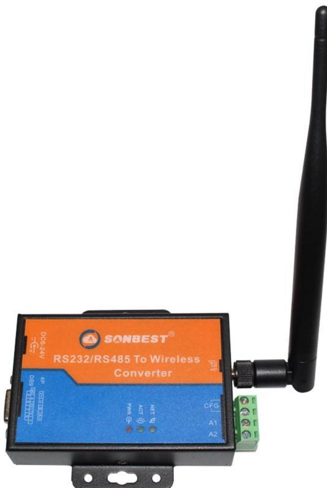
SZ5090A 采用工业通用标准 ZIGBEE 无线通讯接口接口，方便接入 PLC，DCS 等各种仪表或系统，用于监测 RS232 等状态量。内部使用了较高精度的传感内核及相关器件，确保产品具有较高的可靠性与卓越的长期稳定性，可定制 RS232、RS485、CAN、4-20mA、DC0~5V\10V、ZIGBEE、Lora、WIFI、GPRS、NB-IOT 等多种输出方式。
