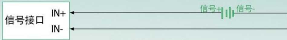
电压采集差分接线图
