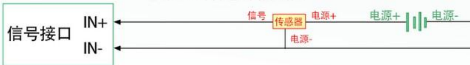
电流三线制差分接线图
