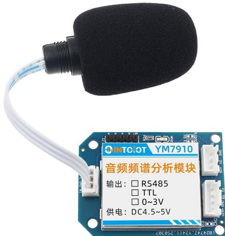
YM7910 采用工业通用标准接口，方便接入 PLC，DCS 等各种仪表或系统，用于监测 12K 音频频率，音频幅值等状态量。内部使用了较高精度的传感内核及相关器件，确保产品具有较高的可靠性与卓越的长期稳定性，可定制 RS232、RS485、CAN、4-20mA、DC0~5V\10V、ZIGBEE、Lora、WIFI、GPRS、NB-IOT 等多种输出方式。
