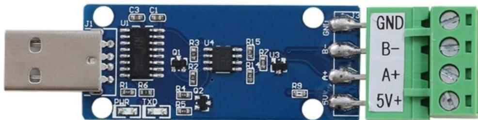
YM815 采用工业通用标准 USB 接口，方便接入 PLC、DCS 等各种仪表或系统，用于监测 RS485 等状态量。内部使用了较高精度的传感内核及相关器件，确保产品具有较高的可靠性与卓越的长期稳定性，可定制 RS232、RS485、CAN、4-20mA、DC0~5V\10V、ZIGBEE、Lora、WIFI、GPRS、NB-IOT 等多种输出方式。
